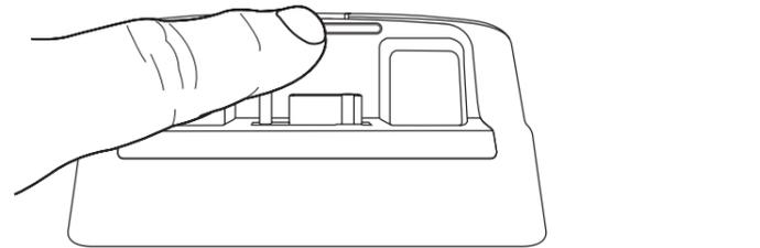
En caso de que deba retirar el adaptador de base para Radio de la base para el hogar, utilice la uña para presionar ligeramente la parte superior del adaptador y luego utilice un objeto largo y delgado, como un clip, un destornillador o algo similar para levantar el adaptador hasta separarlo de la base. Luego quite el adaptador de la base.
