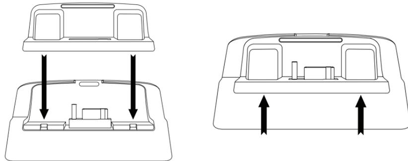
**C.** Una vez que el adaptador esté bien colocado en la base para el hogar, utilice su dedo para presionar ligeramente la parte superior del adaptador contra la base hasta que escuche un clic. El adaptador de base para Radio estará instalado.
